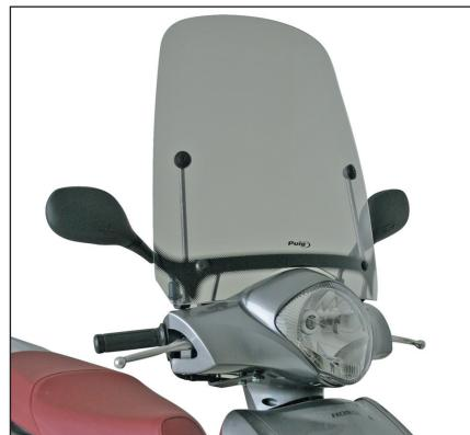
En las revisiones del vehículo es conveniente efectuar también el mantenimiento de apriete de toda la tornillería del carenabris, especialmente los tornillos que fijan éste al vehículo.
