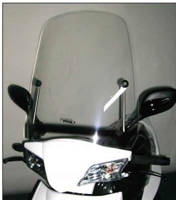
En las revisiones del vehículo es conveniente efectuar también el mantenimiento de apriete de toda la tornillería del carenabris, especialmente los tornillos que fijan éste al vehículo.
